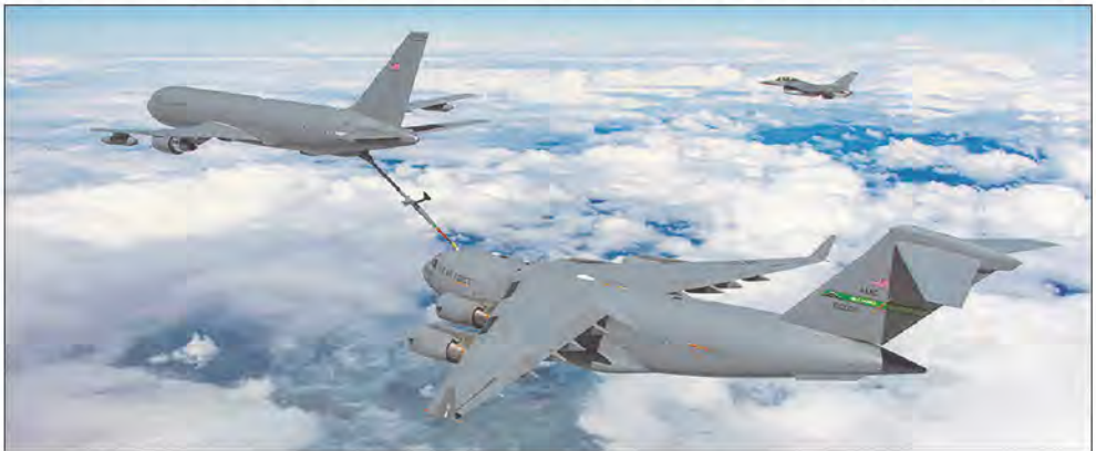
Демонстрационный полет самолета KC-46A по дозаправке военно-транспортного самолета C-17A ВВС национальной гвардии
