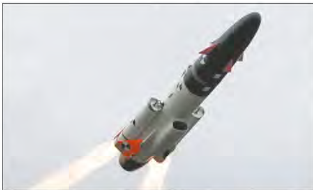
Старт ПКР RBS-15 Mk3 из наземной пусковой установки с применением твердотопливных ускорителей
