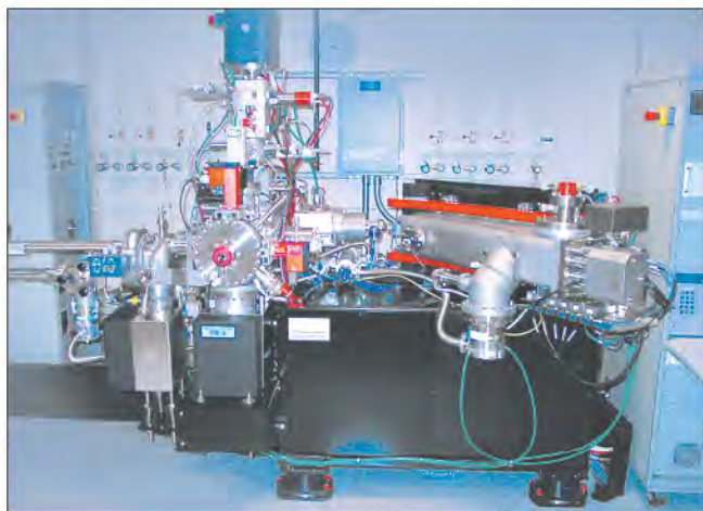
Масс-спектрометр, используемый в Лос-Аламосской лаборатории для определения происхождения ядерных материалов
